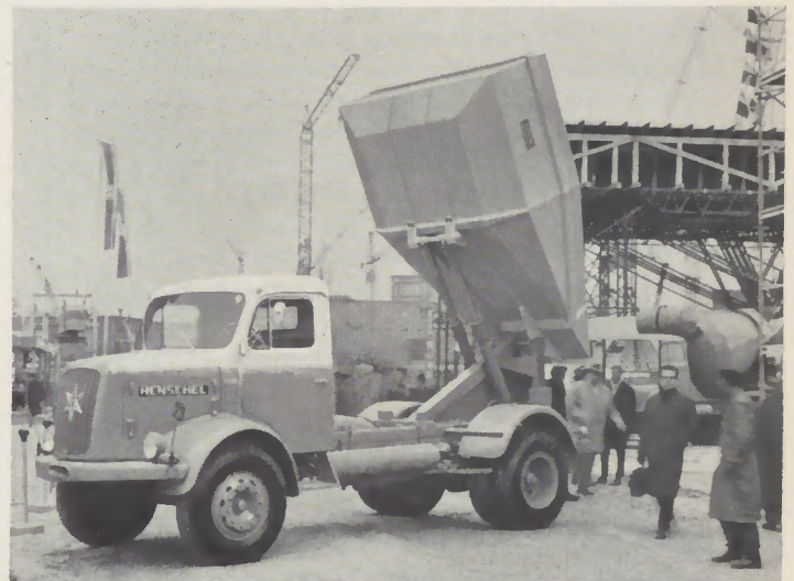
Abb. 4 HS 11 HBM 13 600 kg Gesamt-Gewicht mit 3,5-4 m³ Stetter-Beton-Mulde
