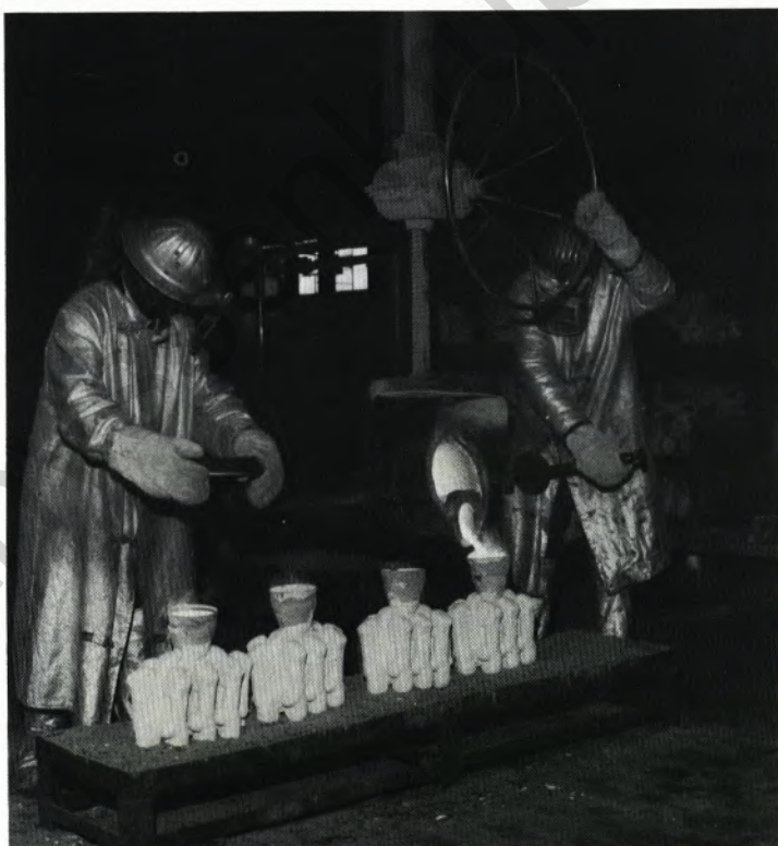
Im Feingußwerk Bochum der Thyssen Gießerei AG. Hier werden hochwertige Teile aus Speziallegierungen gegossen, an die besondere Präzisionsforderungen gestellt werden.
