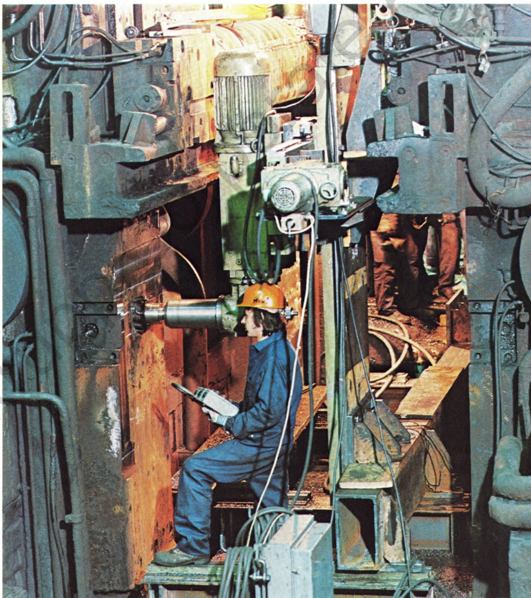
Die Fräsmaschine beim Einsatz im Walzenständer, das obere Bild zeigt den Fräskopf an der zu bearbeitenden Fläche.
