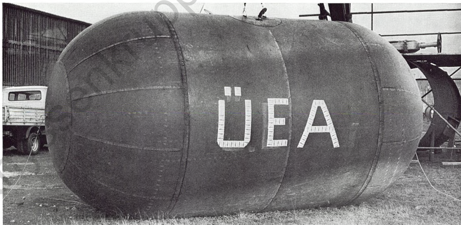
Zur Probe wurde die Blase auch im Freien aufgeblasen. Rechts im Hintergrund ist das Rohrstück zu erkennen, an dem der Abdichtungs Vorgang geübt wurde.
