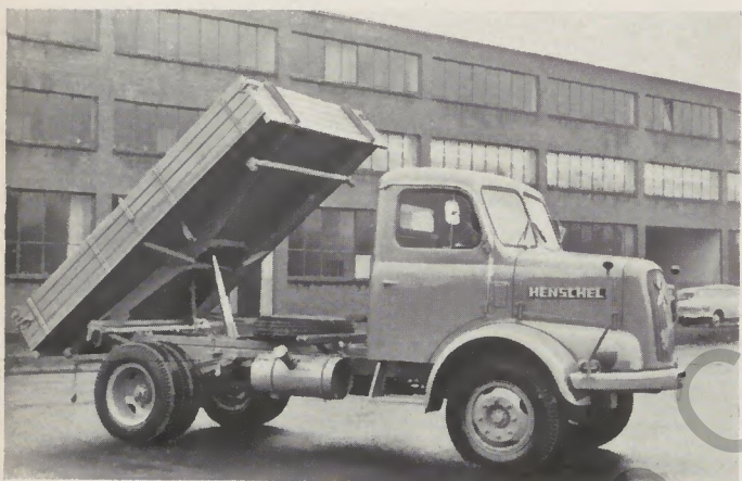
Kipper. Gesamtgewicht 9000 kg, Nutzlast 4800 kg, kleinster Spurkreis-Halbmesser 6,5 m
