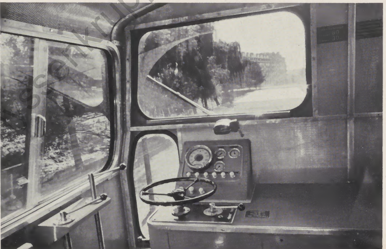
Hauptführerstand des Standardführerhauses. Vollsicht auf das Gleis bis an den Motorvorbau
