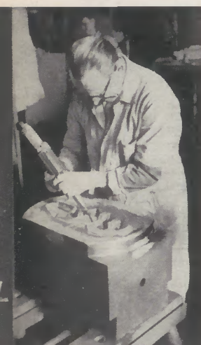
Gesenkschlosser Ernst Wagener poliert das Oberteil eines VW-Kurbelwellengesekes. (Werk Remscheid)
