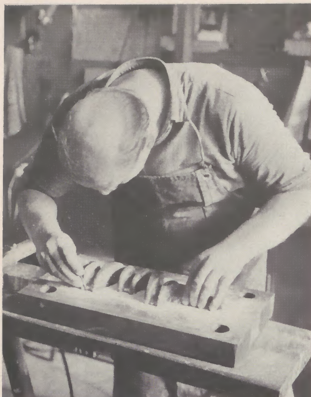
Schnittschlosser Karl Osthoff paßt einen Gipsabdruck in einen Abgratschnitt ein.
