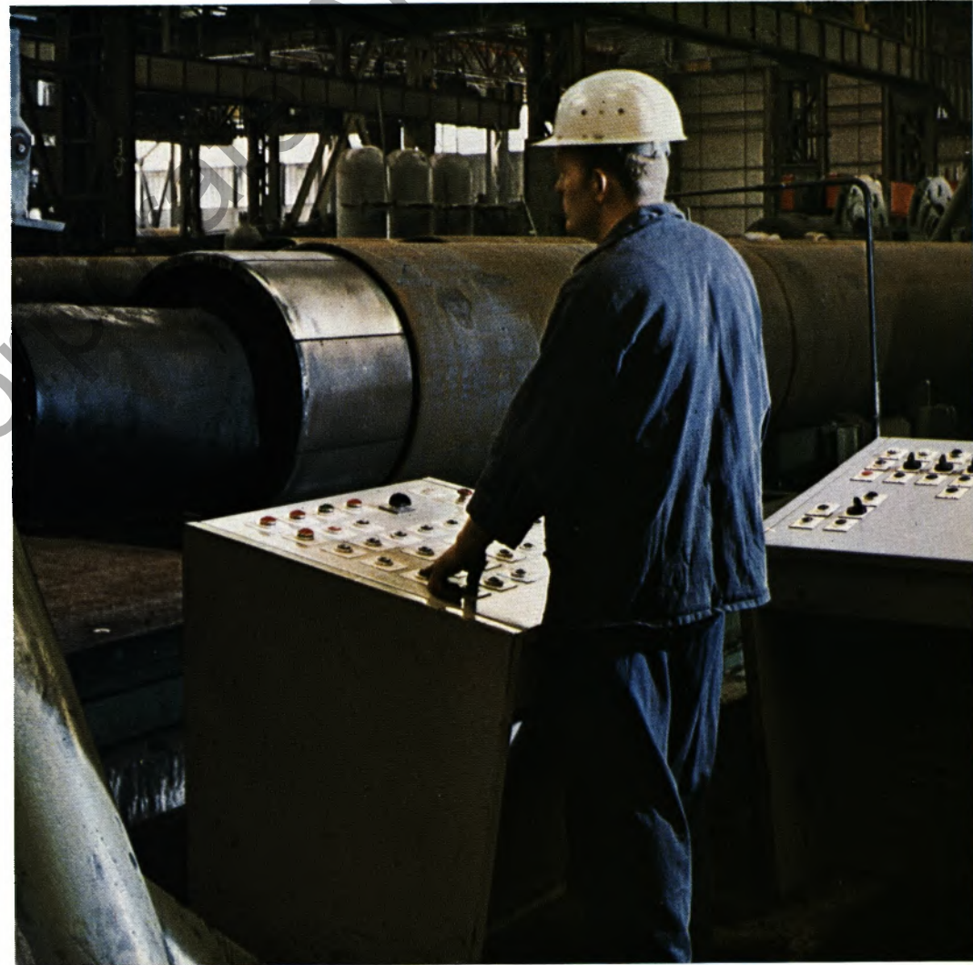
Im mechanischen Expander erhalten die Rohre ihre maßgerechte, endgültige Form.
