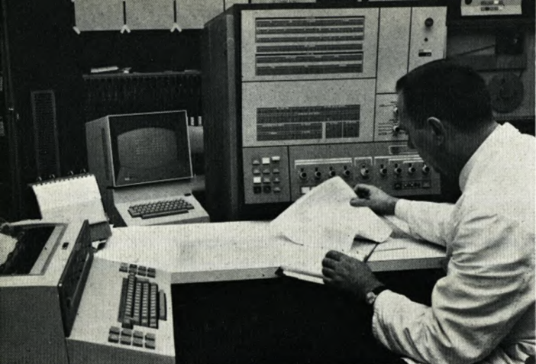
Zentraleinheit IBM System/360. Die Steuerung des Systems kann wahlweise über die Schreibmaschine – im Vordergrund links – oder über den Bildschirm erfolgen.
