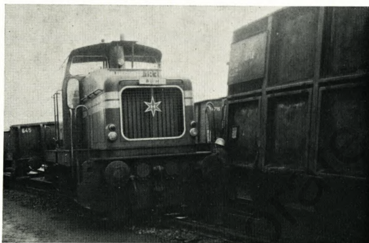
Eine Flankenfahrt in einem Handweichenbereich war die Ursache dieser Entgleisung. Die Folgen: 1 Lok und 2 Wagen entgleisten und wurden beschädigt. Die Gesamtkosten dieses Schadens, die nicht gering sein dürften, sind noch nicht ermittelt.
