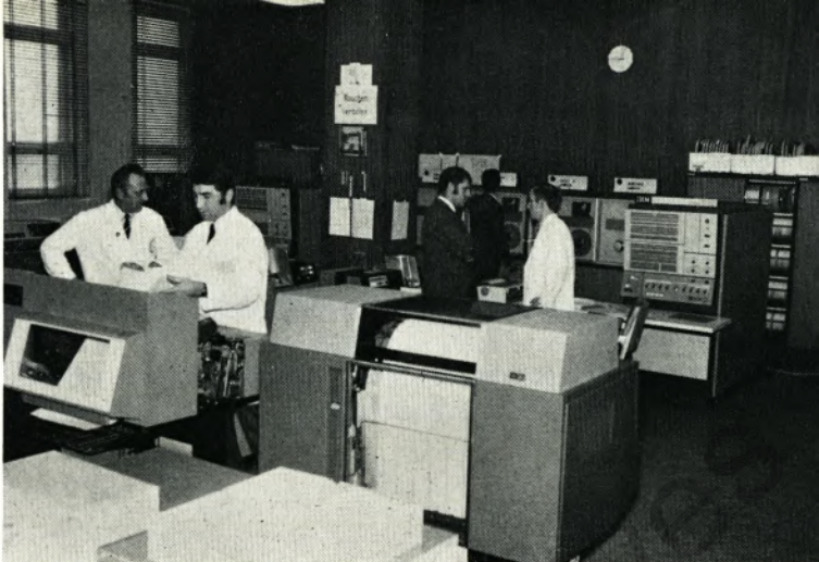
Gesamtüberblick des Maschinenraumes. Im Vordergrund Drucker, dahinter Zentraleinheiten und im Hintergrund Bändeinheiten.
