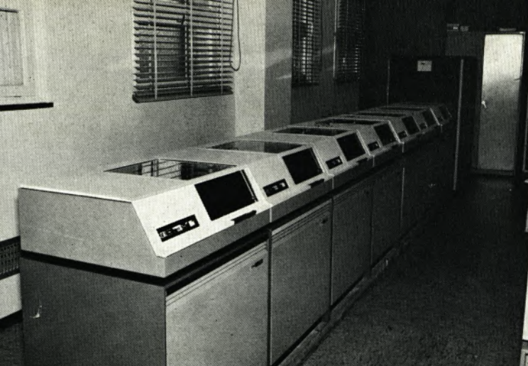
Magnetplattenspeicher IBM 2311. Auf diesen Einheiten werden u. a. sämtliche Wagenveränderungen, die mit Bildschirmen eingegeben werden, festgehalten und gespeichert.
