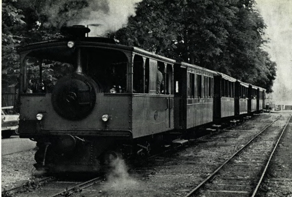
Seit mehr als 80 Jahren dampft die Chiemsee-Bahn über die 1,8 Kilometer lange Strecke von Prien zur Anlegestelle der Schiffe in Stock am Chiemsee. Die 1887 von Krauss & Cie in München gebaute Dampflokom schaff 15 km/h Höchstgeschwindigkeit und kann mit ihren sechs Wagen, von denen einer sogar 1. Klasse führt, 350 Fahrgäste befördern. Unser Bild zeigt den romantischen Zug bei der Abfahrt in Stock.
