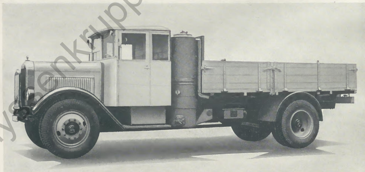
HENSCHEL-5-t-LASTWAGEN MIT HOLZKOHLENGAS-GENERATOR
