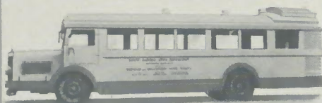
Henschel-Omnibus, Bauart Dr. Deiters mit Holzgas-Generator Fassungs-Vermögen: Bis 50 Pers.
