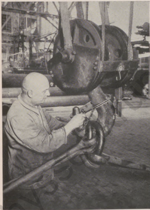
Abb. 1: Neue Sicherheitslasche für Kranhaken
