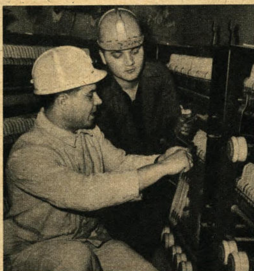
▼ Im Widerstandsraum für die Drehstrommaschine hat Werner Karger, rechts, die Aufgabe, die Kupferabgänge anzufertigen und anzubringen. Meister Siegfried Kreutz, der Leiter der Lehrwerkstatt, gibt ihm dazu letzte Anweisungen
