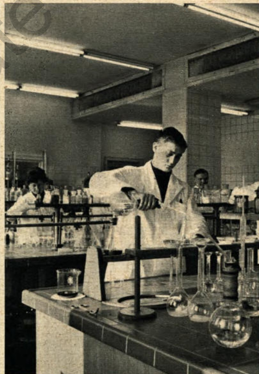
1 Ursula Jochmann bei der Untersuchung der Zinnauflage von Weißblechproben
