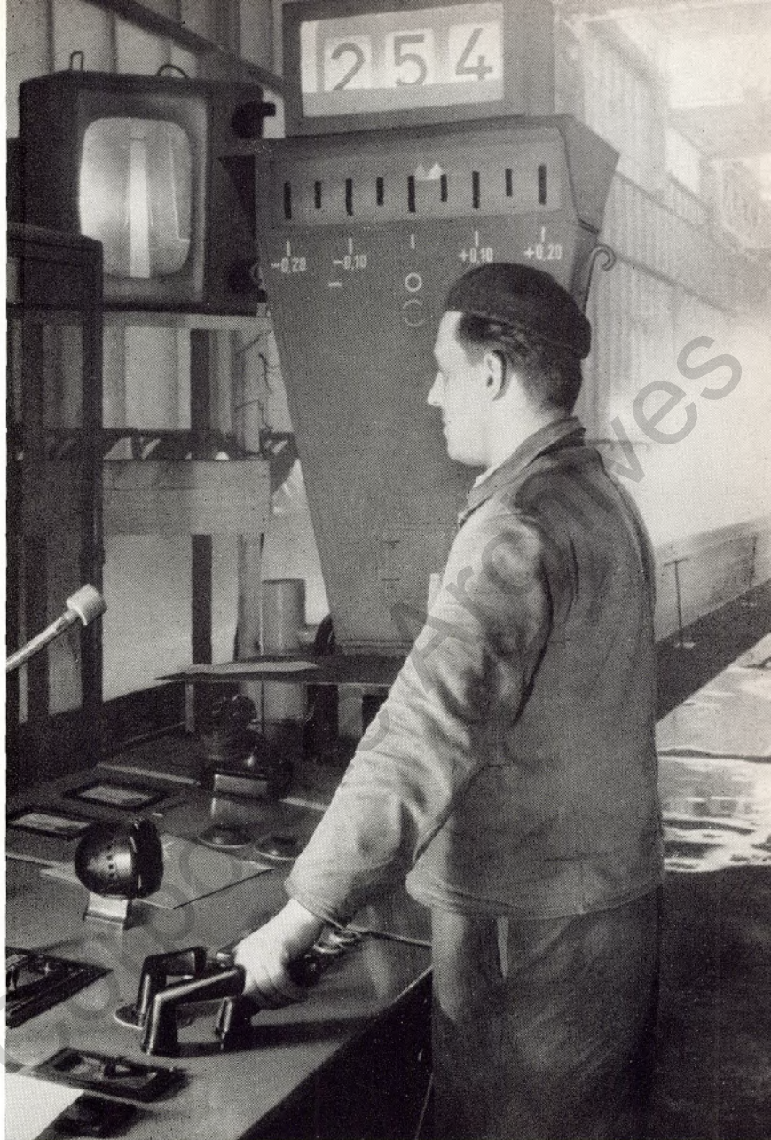
Fertigwalzer Helmuth Sinngen, vor dem Kriege im Blechwalzwerk unserer Hütte tätig, kann durch ein Fernsehgerät von seinem Steuerstand an Gerüst 10 der Breitbandstraße den Lauf des zur Haspel fließenden Breitbandes genau verfolgen
