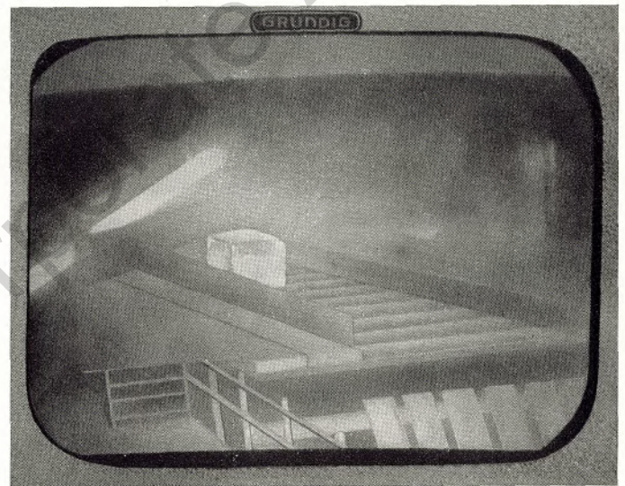
So erscheint der Einlauf zum Walzgerüst der Blockbrammenstraße auf dem Fernseh-Bildschirm im Ziehstand des Tiefofens
