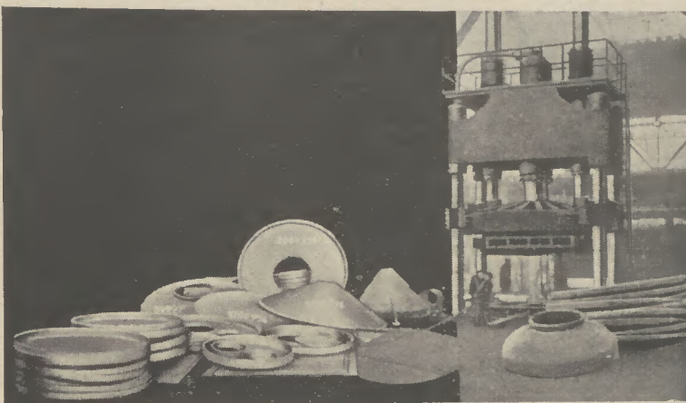
Erzeugnisse der Ruhrstahl-A.-G. Kesselbleche, Kesselmäntel, Kesselböden, Diffusorhaube von 4100 mm Ø, aus einem Blech gepreßt, Wellrohre und Spezialböden
