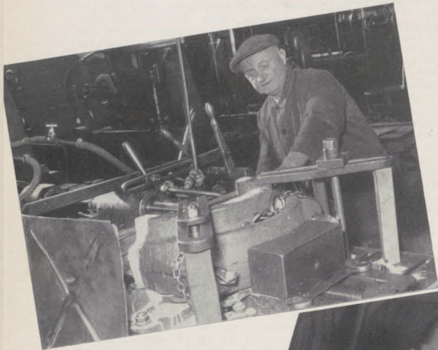
Karl Aschenbrenner Fräser im Bökerbau, Saal I, fräst auf der Abwälzfräs- maschine Zahnräder und Ritzel und bohrt Ankerlöcher in Kreuzkopflager
