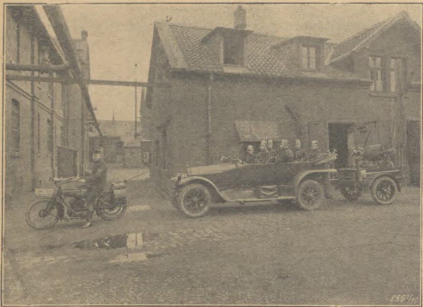
Abb. 4. Ein alter, außer Dienst gestellter Personenwagen hat eine Einrichtung erhalten, um ein Fahrzeug mit Ausrüstungsgegenständen schleppen zu können. 1927
