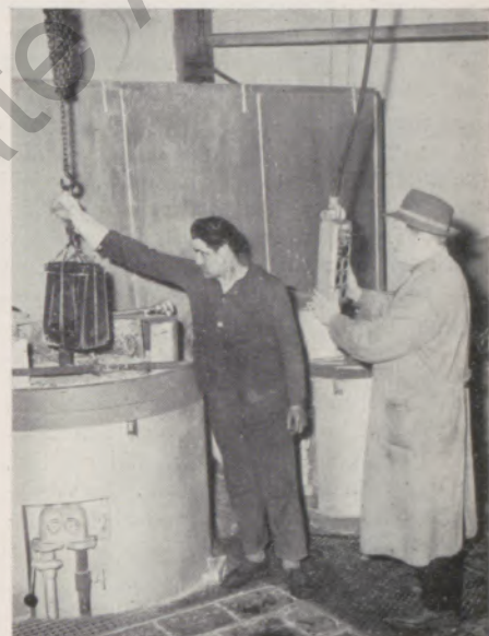
Härtemeister Günter Pfaffenhöfer und Mitarbeiter Walter Stamm beim Einhängen eines Werkzeuges in eines der Salzbad
