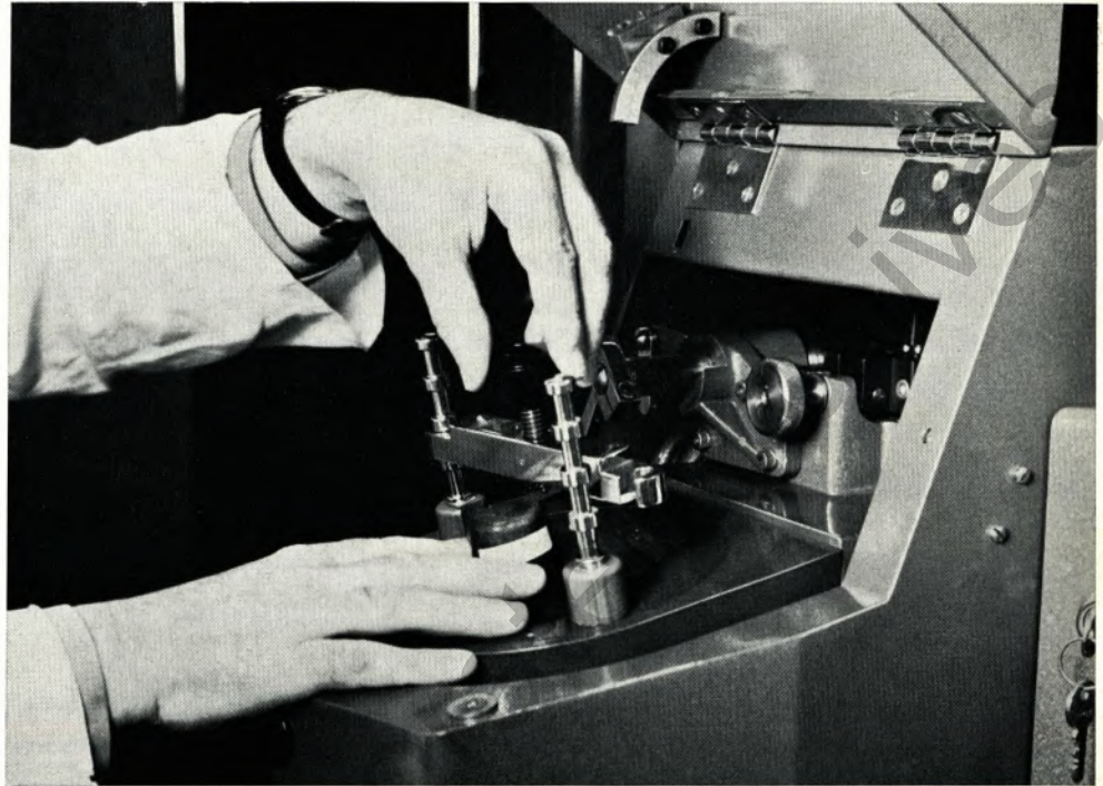
Das ist der Funkenstand des Spektrometergerätes. Hier werden die nach entsprechender Vorbereitung gewonnenen Proben eingespannt. Nach dem Schließen der Funkenkammer findet zwischen der Probe und einer Gegenelektrode eine elektrische Entladung statt.
