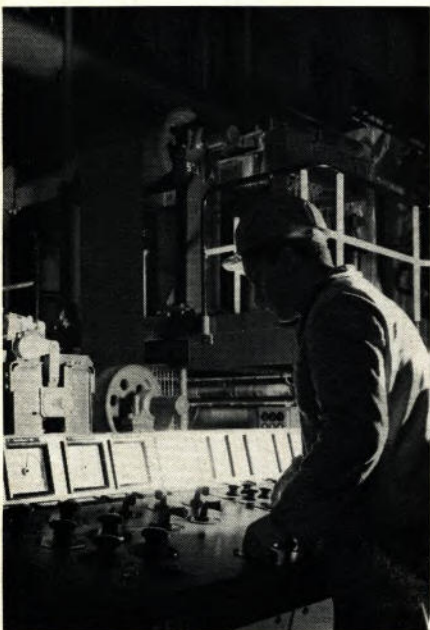
Titelseite: 140 Meter lang ist der Durchlaufglühofen – eine der wichtigsten „Nebenanlagen“ des neuen Kaltwalzwerkes. Unser Bild zeigt nur einen kleinen Ausschnitt dieser für die Qualität des Bandes so wichtigen Anlage: den Einlauf, den Franz Niehaus von seinem Steuerpult aus regelt
