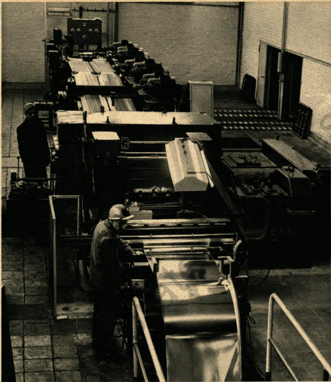
▲ Der Auslaufteil der Verzinnungsanlage: im Vordergrund Richtmaschine und Schere, im Hintergrund: Sortier- und Stapleinrichtung. Vorn: Ernst Illner, hinten: Clemens Zajdowicz
