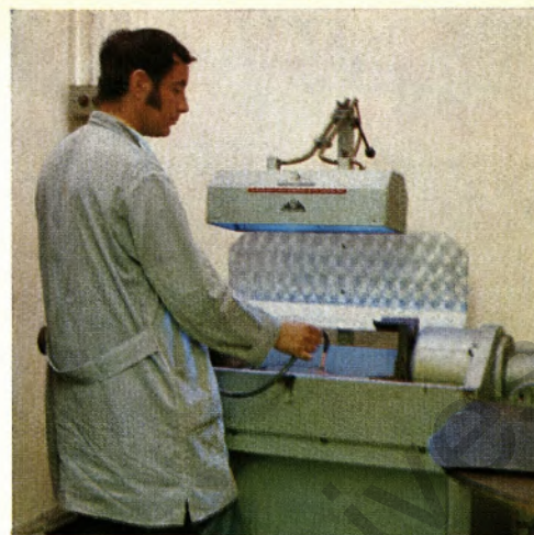
Prüfer Karl-Heinz Wißig bei der Fluxprüfung (ein Magnetpulver-Verfahren zum Feststellen von Oberflächenfehlern am Walzdraht).
