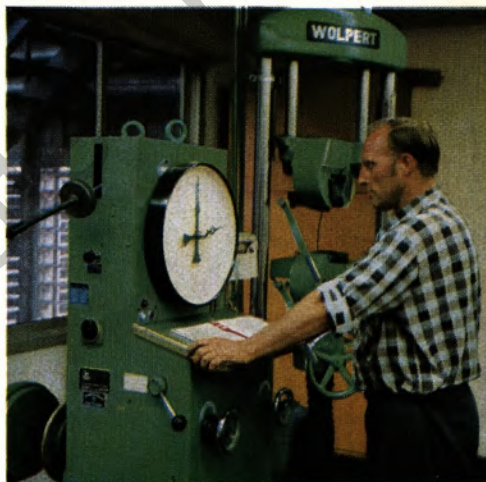
Oben: Festigkeitsprüfer Manfred Schael an der Zerreißmaschine. Hier werden die Festigkeitseigenschaften des Walzdrahtes ermittelt. Unten: Untersuchung von Walzdrahtproben auf Oberflächenfehler. Am Mikroskop (von links) die Prüfer Herbert Rieger und Karl-Heinz Wißig.
