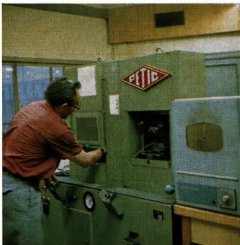
Kolonnenführer Georg Fischer überprüft im Stauchversuch die Oberflächengüte der Walzdrahtproben.
