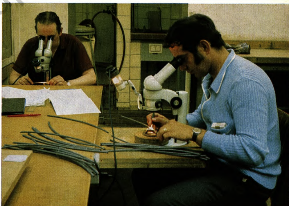
Oben: Festigkeitsprüfer Manfred Schael an der Zerreißmaschine. Hier werden die Festigkeitseigenschaften des Walzdrahtes ermittelt. Unten: Untersuchung von Walzdrahtproben auf Oberflächenfehler. Am Mikroskop (von links) die Prüfer Herbert Rieger und Karl-Heinz Wißig.
