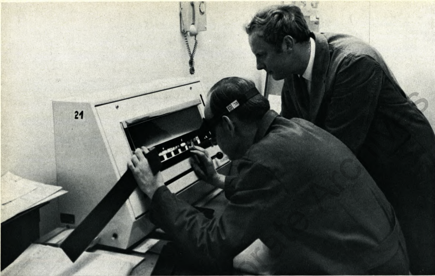
Am Röntgenfilmbetrachtungsgerät wird die Qualität der durchstrahlten Schweißverbindung festgestellt und an Hand eines international genormten Kataloges eingestuft. Unser Bild zeigt den Autor unseres Berichts, Dr.-Ing. W. Zwintscher (rechts) und seinen Mitarbeiter, Röntgenprüfer Gerhard Westermann.
