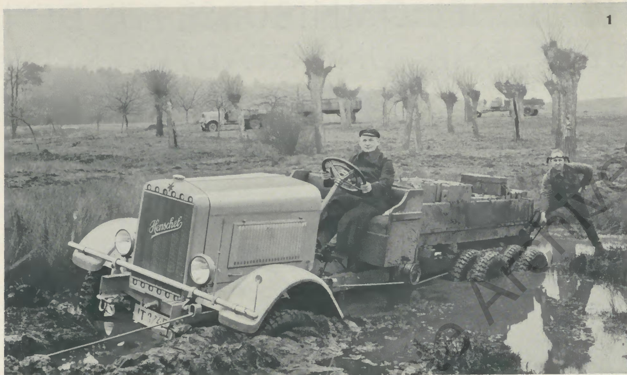
Henschel-Dreiachs-Gelände-Fahrgestell mit Belastung in sumpfigem Gelände zieht sich mit eigener Kraft mittels Spill heraus
