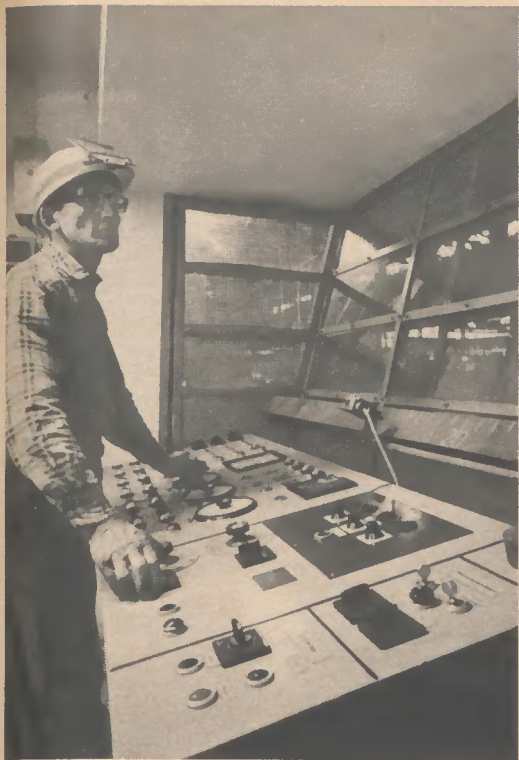
▲ Ein Blick in den Steuerstand; vor den Bedienungseinrichtungen für das automatische Hubwerk, für das Legierungs-Zugabesystem und die Vakuumpumpen der Bedienungsmann August Olk
