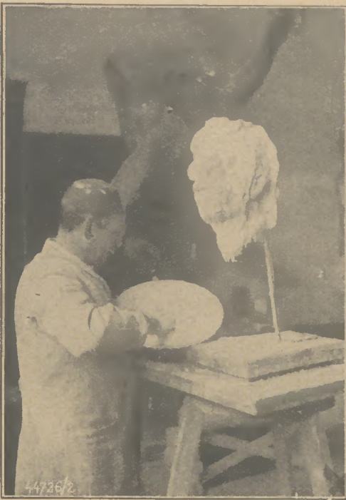
Das Tonmodell wird zum Herstellen des Gipsmodells mit einem Gipsmantel überzogen
