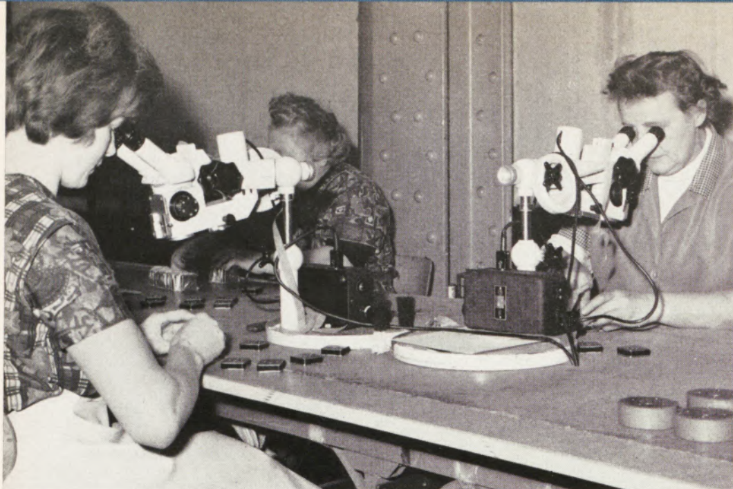
Unsere Mitarbeiterinnen Frau Wichmann und Frau Schäfer in der Endkontrolle der Ringspalt- Montage beim Prüfen und Säubern des Luftspaltes an Lautsprecher-Magnetsystemen
