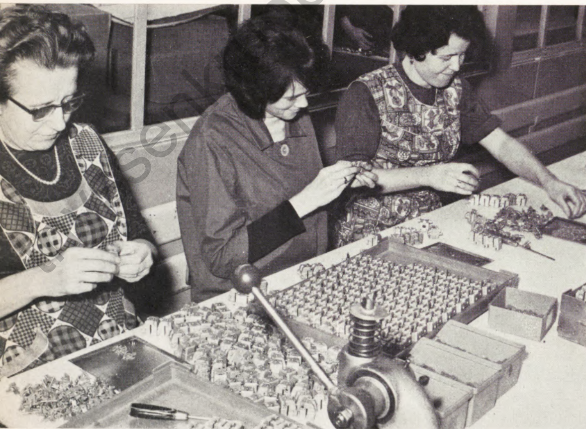
Bild Mitte: Unsere Mitarbeiterin Frau Riedel in der End- kontrolle bei der maßlichen Prüfung von Magneten am Sorex-Meßgerät
