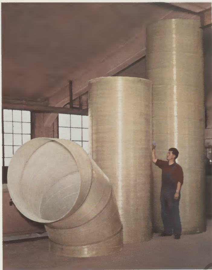
Rohre aus Bendurplast
