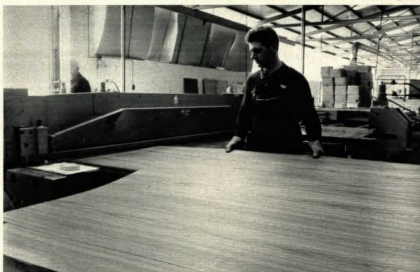
Die erste Station auf der Fertigungsstraße für Platal-Türen: der kunststoffbeschichtete Stahl wird in Länge und Breite zugeschnitten
