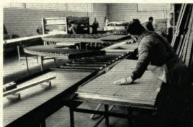
◀ Einbringen der Füllung: Außer ihrer schallhemmenden und wärmedämmenden Wirkung gibt sie der Platal-Tür den Klang herkömmlicher Holztüren
