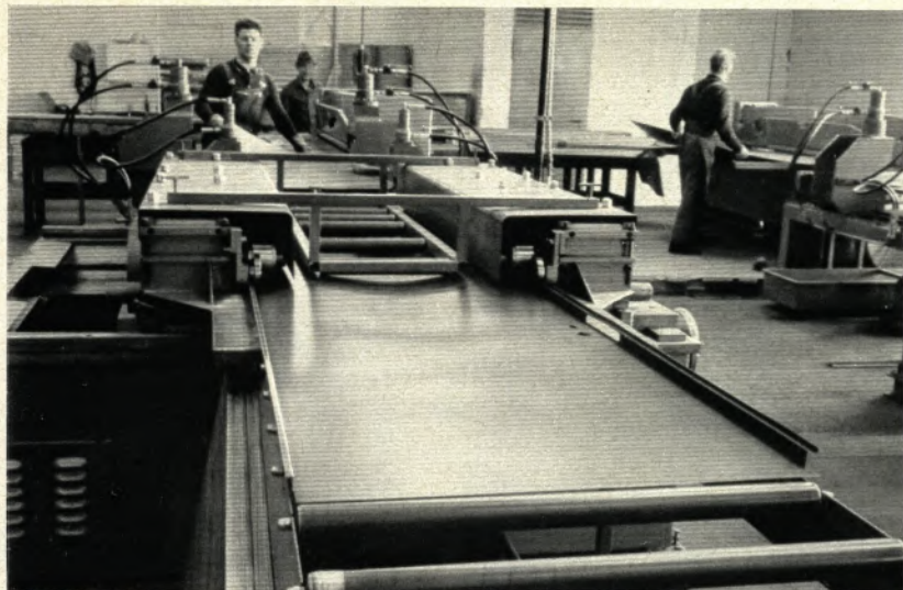
▲ Diese Maschine besorgt die Seitenprofilierung
