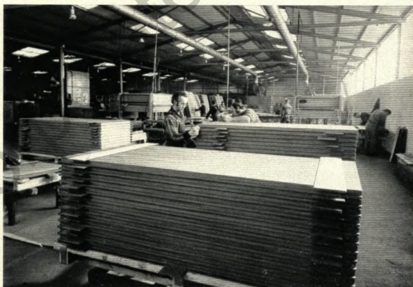
▲ Die Platal-Tür ist fertig. Bevor sie jedoch die Halle verläßt, wird sie noch einer Kontrolle unterzogen und gesäubert
