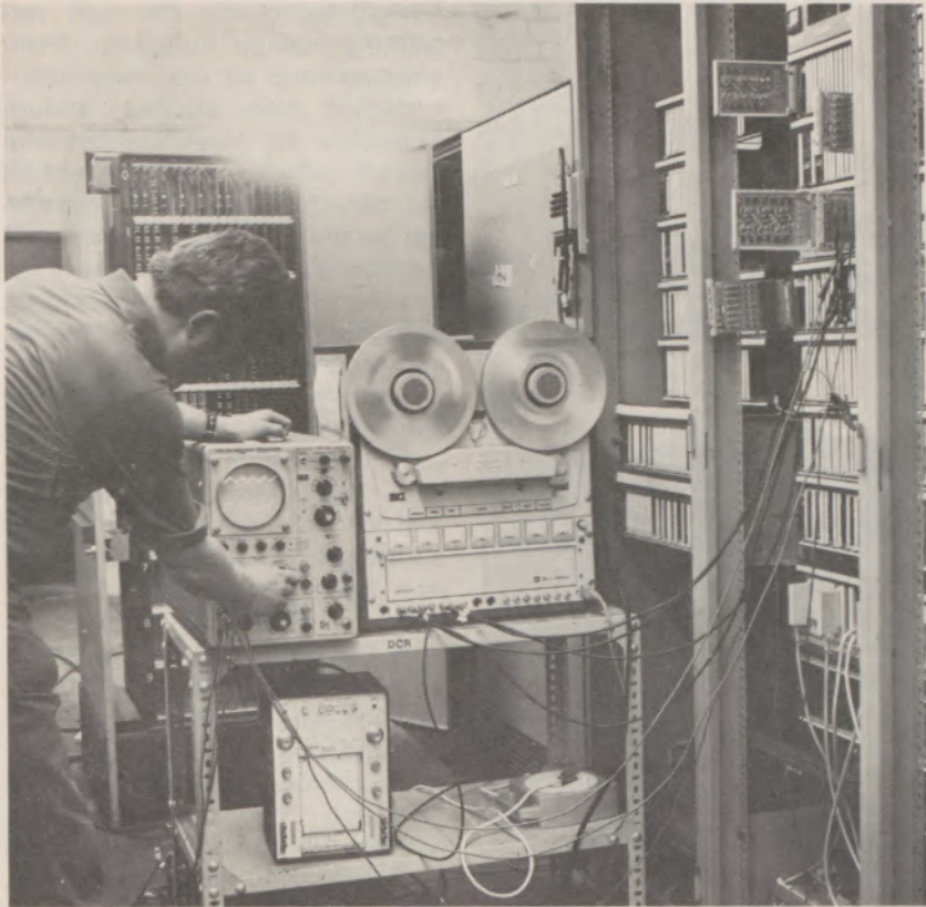
^ Vorarbeiter Gerhard Noffke überprüft im Kaltwalzwerk 1 die Regelung der DCR-Straße am Oszillograf und Magnetbandspeicher.
