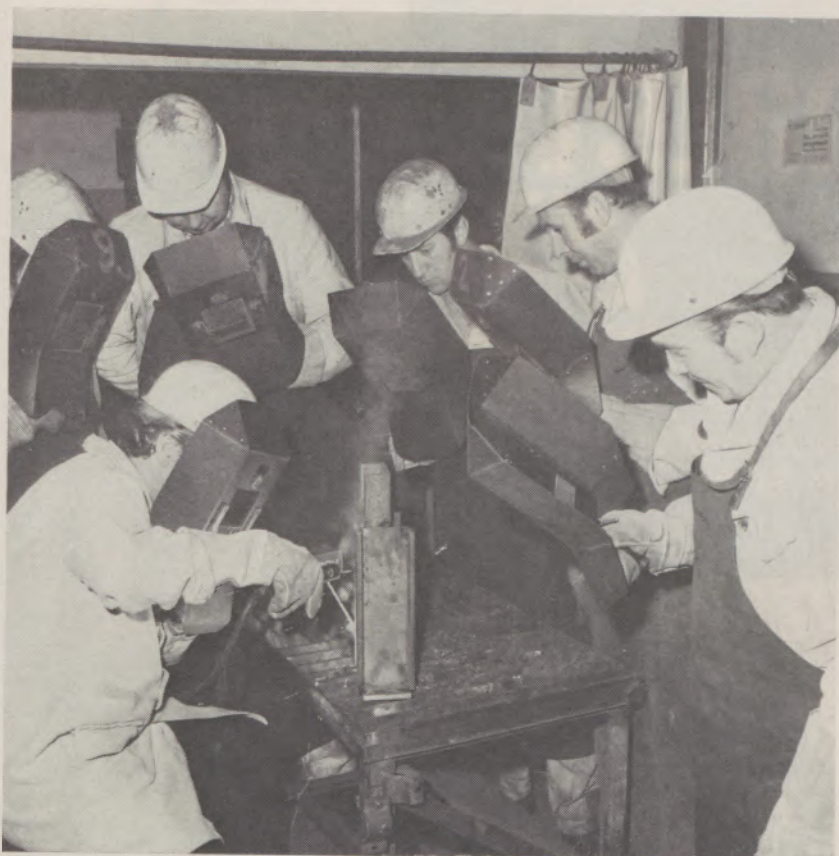
Im Technischen Ausbildungswesen werden für Mitarbeiter verschiedener Betriebe und Abteilungen Grundlehrgänge im Metalllichtbogenschweißen, im Gasschweißen und Brennschneiden durchgeführt. Im Bild versucht sich ein Lehrgangsteilnehmer im Metalllichtbogenschweißen an einer Profilsäule, während die andern den Vorgang durch einen Schutzschild beobachten.
