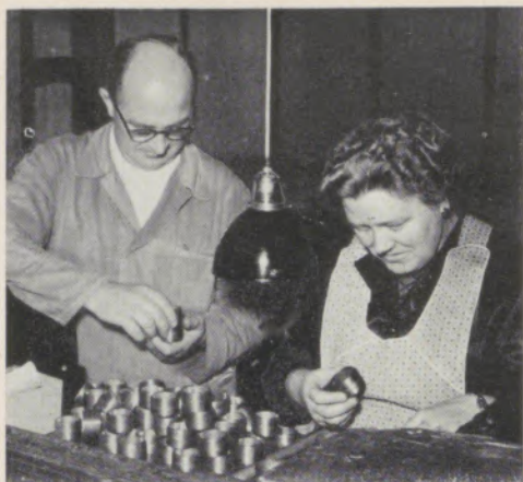
Bild 8 — Kontrolle der fertigen Fittings
