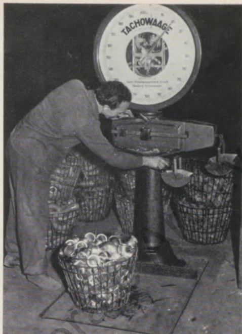
Bild 7 — Rohfittings auf der Zählwaage
