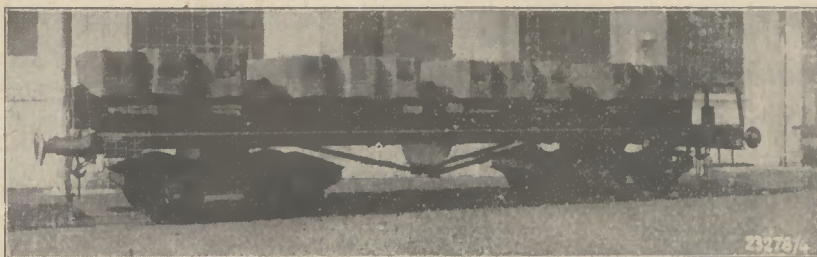
Bild 8: Schlackentopfwagen zur Aufnahme von Schlacke
