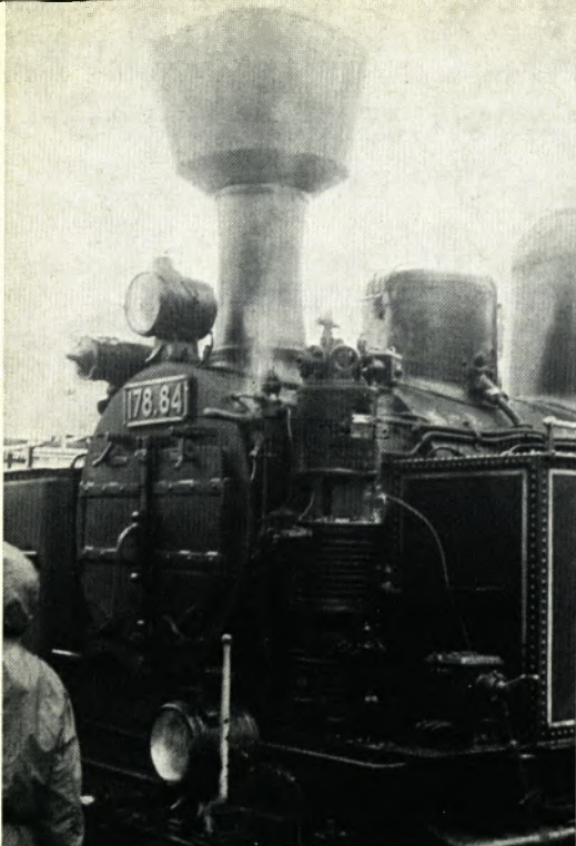
Ein typisches Merkmal altösterreichischer Dampflokomotiven ist der Kobelrauchfang.
