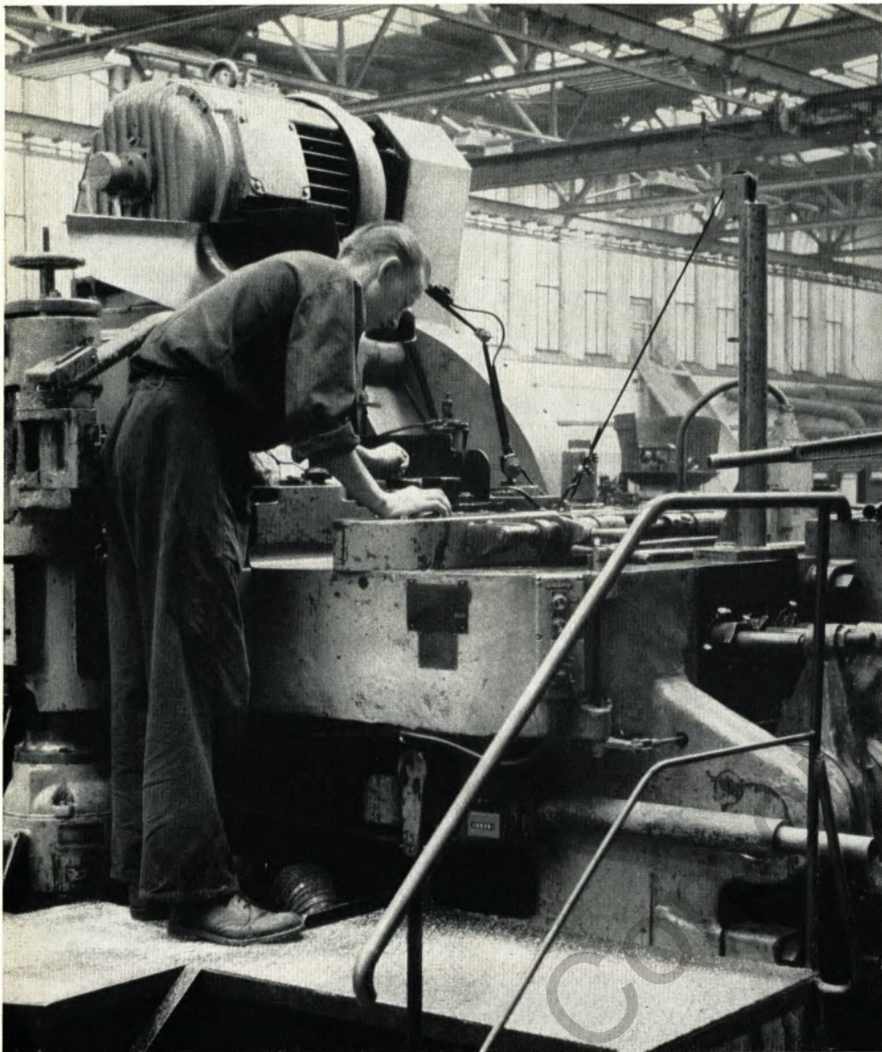
Teilansicht eines amerikanischen Schrauben-Automaten, der alle sechs Arbeitsgänge in einem Zug erledigt.
