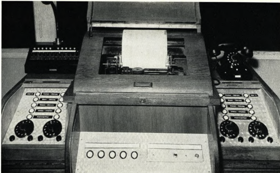
Der bei der NH entwickelte Störungsschreiber auf der Haspel-Steuerbühne an der Drahtstraße III
