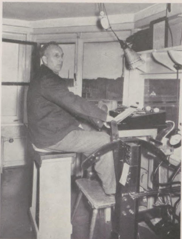
Steuerung der Gleisbremse für den Ablaufberg Bahnhof Grünstraße Lichtbilder: Obering. Adolf Pollmann (5), B. Maruschke (1).
