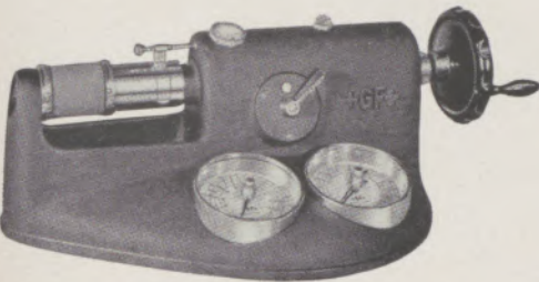
Prüfapparat zur Bestimmung der Druck- und Scherfestigkeit
