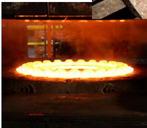
Schmieden eines Kettenrads für Minenbagger in der größten Schmiedepresse Europas
