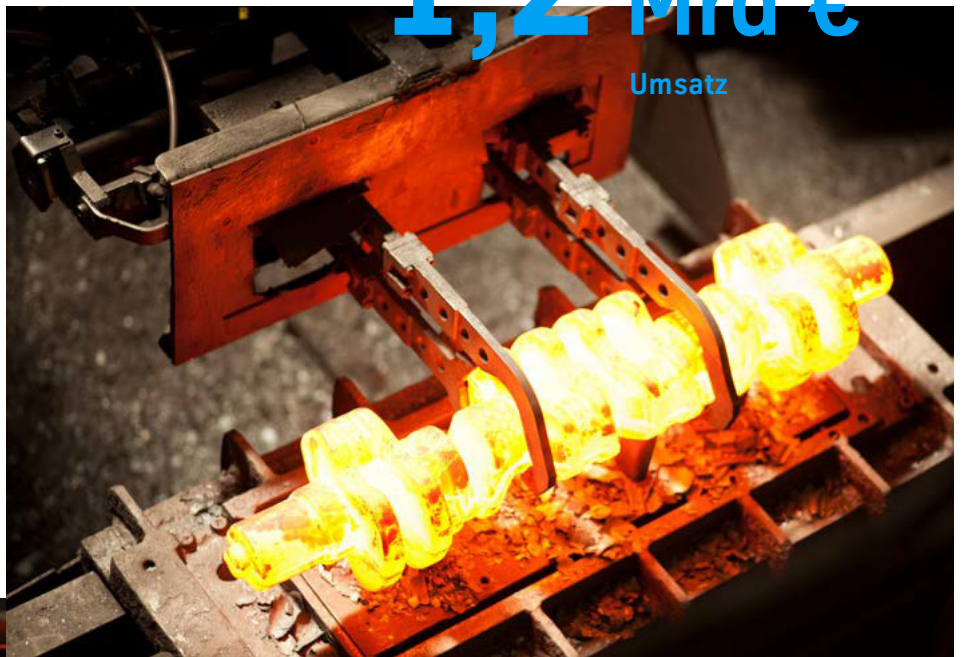
Herstellung einer Lkw-Kurbelwelle im Werk Campo Limpo in Brasilien
