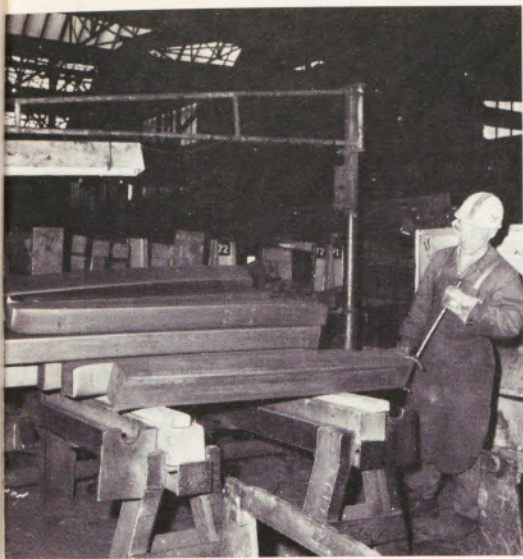
Unser Mitarbeiter Adolf Nolde demonstriert die Arbeit, wie sie an den alten Putzböcken üblich war.
