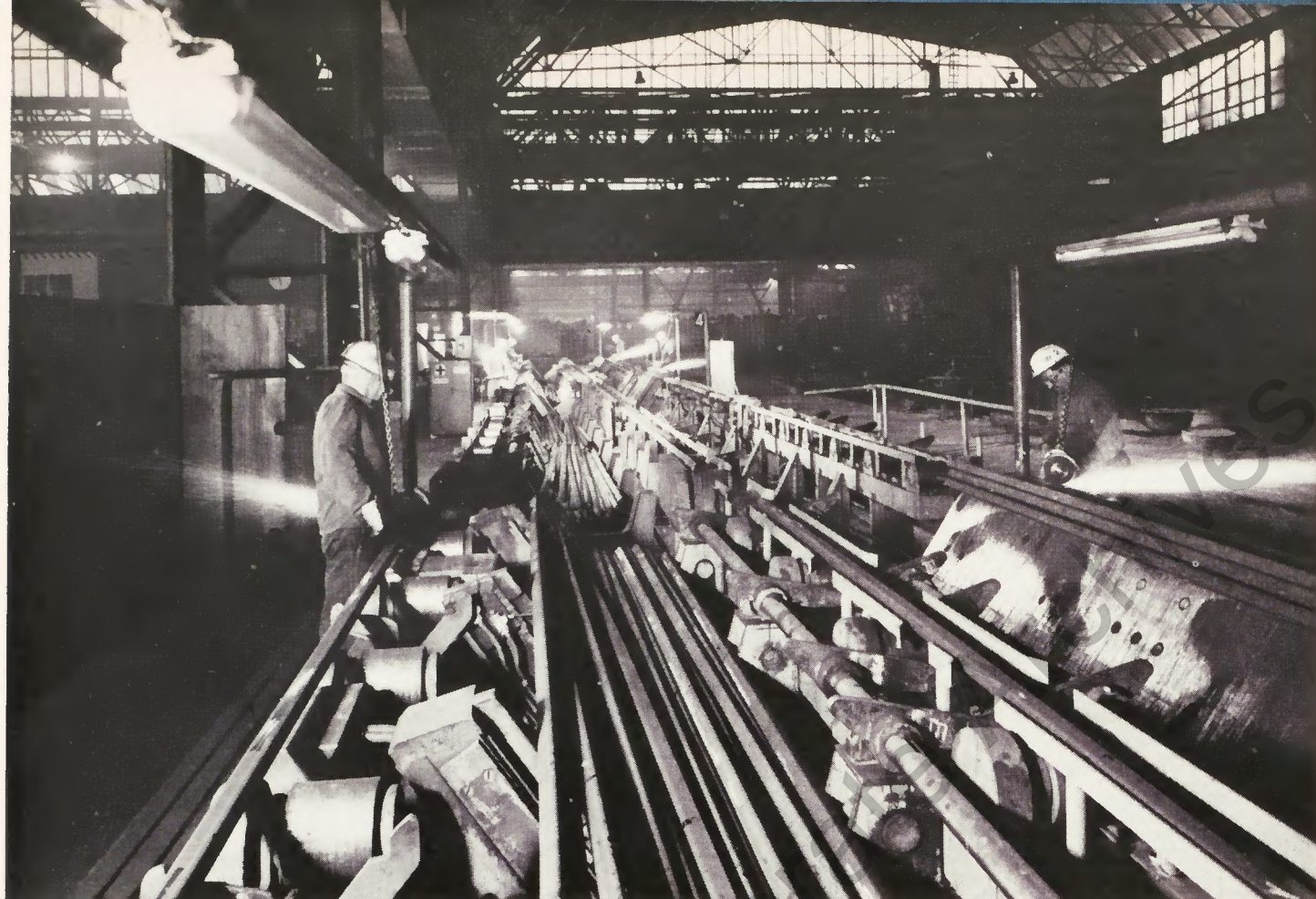
Mechanisierte Knüppel-Putzstrecke (Teilansicht)
