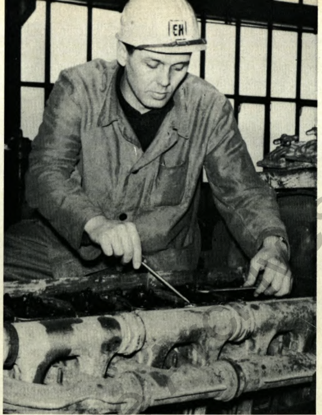
Vorarbeiter Paske kontrolliert das Ventilspiel an einem Dieselmotor.
