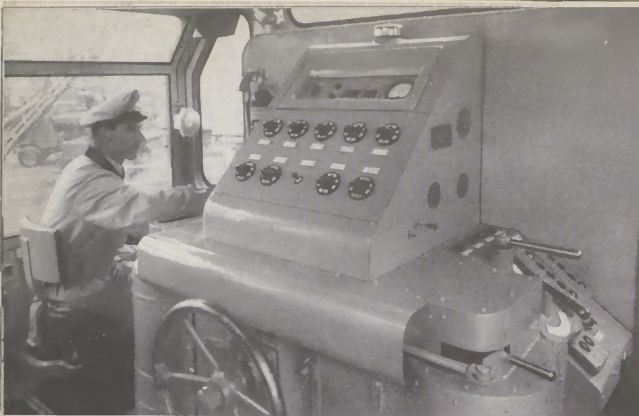
Abb. 9 Blick auf den Steuertisch im Führerhaus
