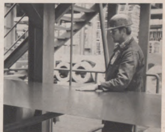
► Günter Kinzig, 36, und seit 1955 bei Hoesch, ist Steuermann am Auslauf; er kontrolliert gerade die Bandspannung
