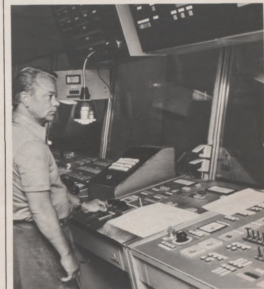
▲ Willi Heidereich im Steuerstand an der Fertigstaffel. Kontrollieren und Korrigieren sind seine wichtigsten Aufgaben. In den Anzeigergeräten über seinem Kopf erscheinen Informationen über das durchlaufende Band
