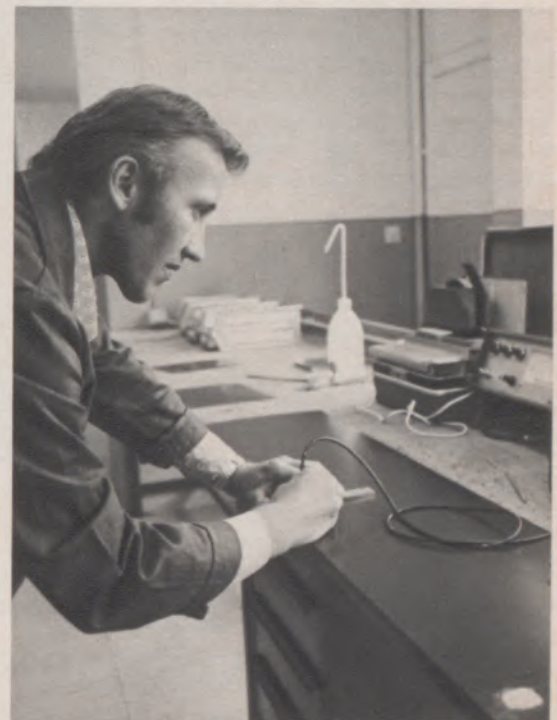
▼ Manfred Schulte, 35, gelernter Stahlbauschlosser und seit 1956 bei Hoesch, ist Vorarbeiter und kontrolliert auf unserem Foto die Temperatur des Trockenofens
