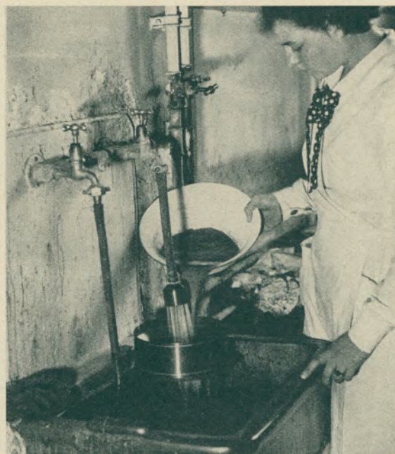
Abb. 7. ... unter einer Brause ausgewaschen, wobei die feineren Bestandteile abfließen, während die versteinerten Kleinlebewesen im Sieb zurückbleiben.
