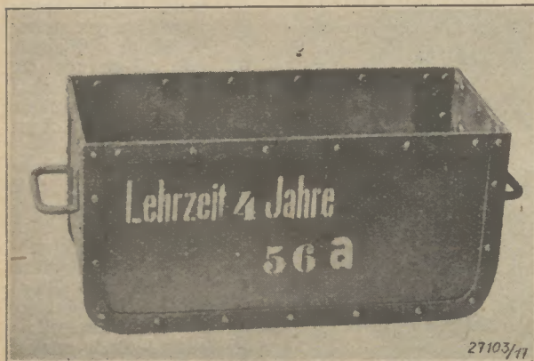
Bild 4. Facharbeit für Bauschlosser: Spänekasten. Ausführung
