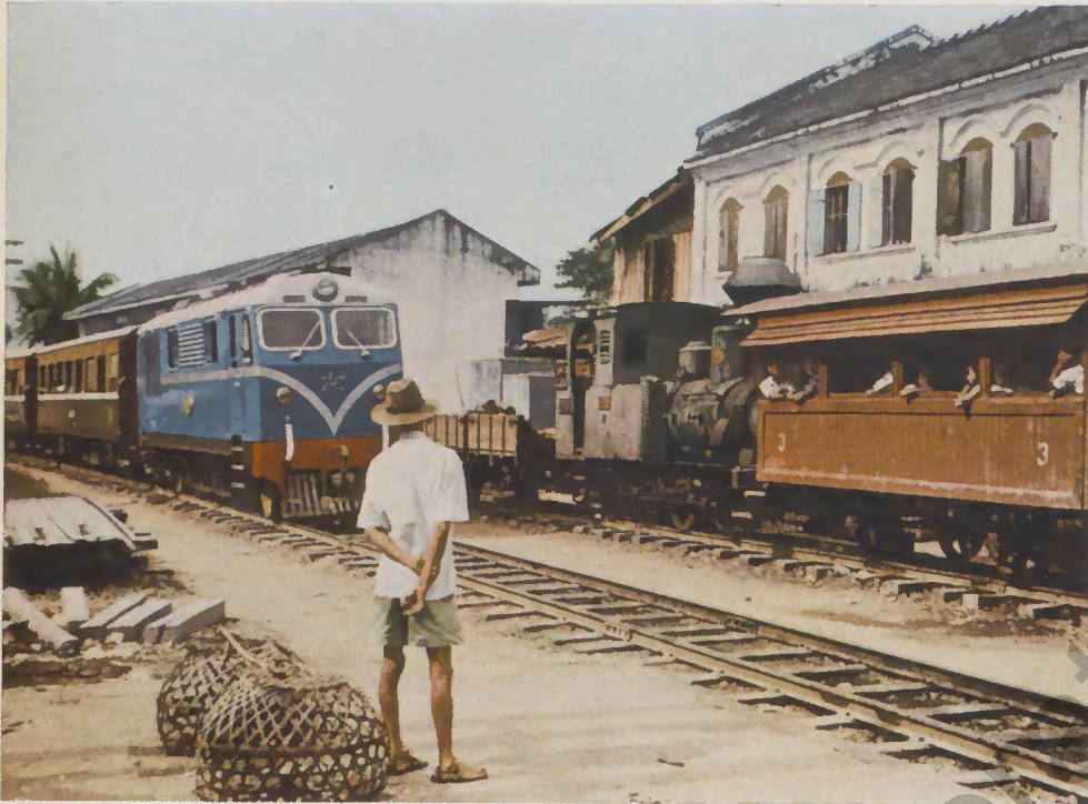
Diesel-hydraulische Henschel-Lokomotiven des Baumusters 1C1 in Stahl-Leichtbauweise fahren im Dienst der Thailändischen Staatsbahn. Sie sind im Schnellzug-Verkehr auf der Strecke Klong Sahn (Bangkok) – Mahatschi eingesetzt. Spurweite 1000 mm, Dienstgewicht 33 400 kg.
