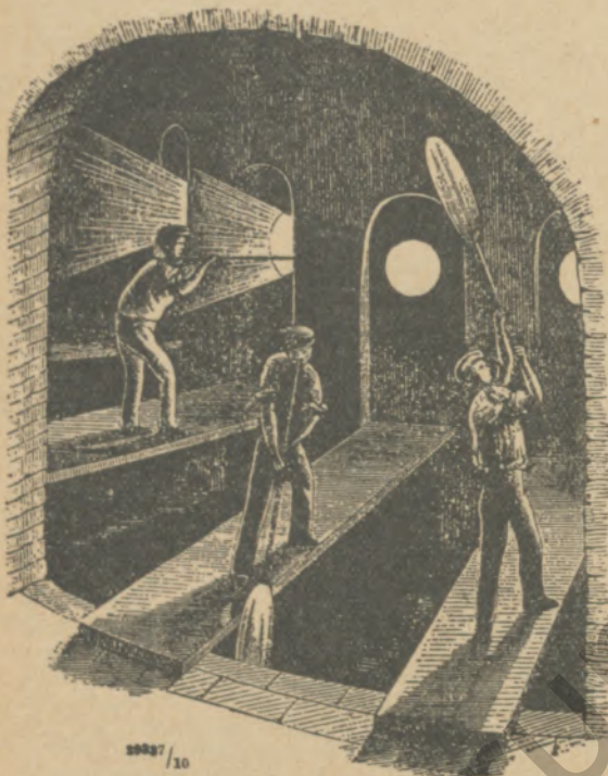
Durch wiederholtes Eintauchen, Blasen und Schwenken über einer Grube entsteht der Glaszylinder
