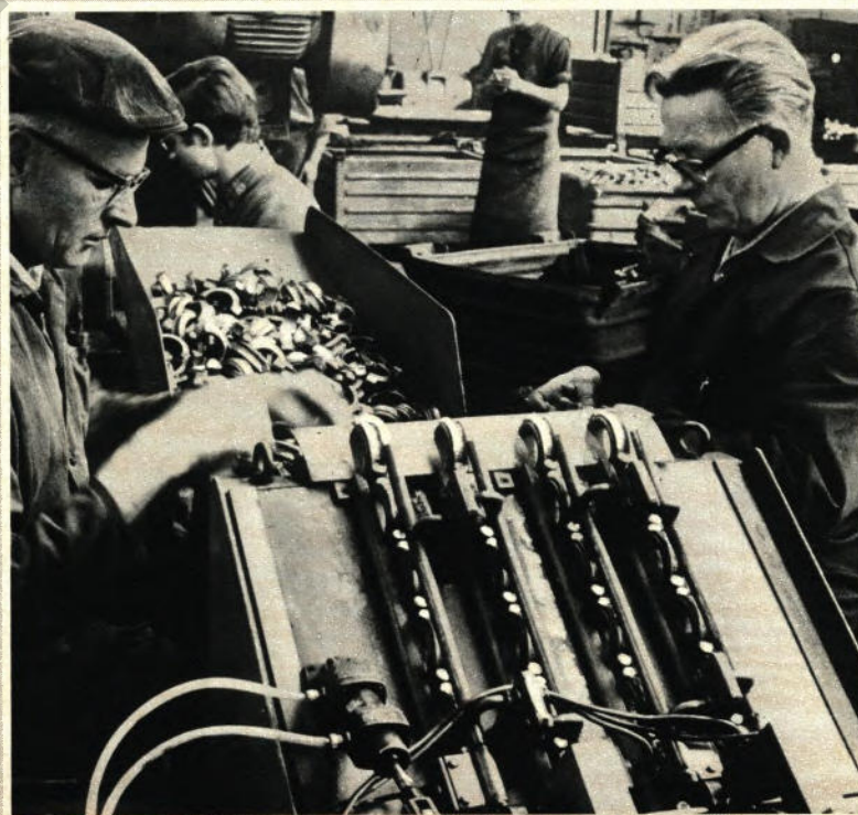
Einer der wichtigsten Arbeitsabläufe ist die Endkontrolle. Oben: Klaus Friedrichs bei der Festigkeitsprüfung und links Paul Kraft und Alfred Flüge am Magnetisierungsautomaten für die Rißprüfung
