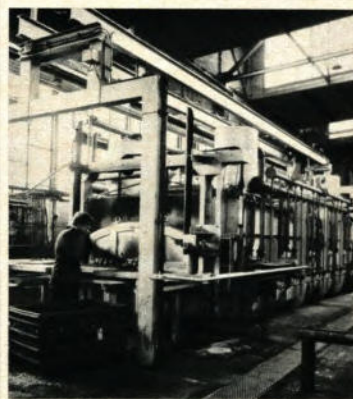
◀ Stanoja Pantic am Eingang der Durchlaufanlage, in der die fertiggeschmiedeten Teile vergütet werden
