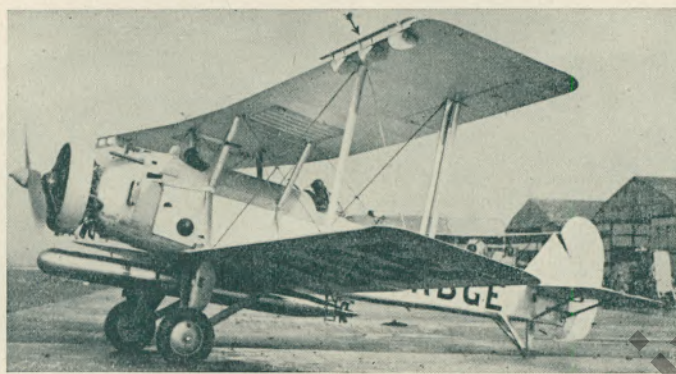
Abb. 6. Vickers Schiffsflugzeug „Wildebeest“ mit 525-PS-Bristol-„Jupiter XI F“-Motor, im „Lownemding“ eingebaut, startet mit Torpedo, der zwischen dem achslosen Fahrwerk aufgehängt ist. Das Torpedoflugzeug, welches mit Handley-Page-Spaltflügelklappen ausgerüstet ist, wird auch mit dem Armstrong-Siddely-„Jaguar-Major“-Estermotor geflogen. (Archiv: v. Römer.)
