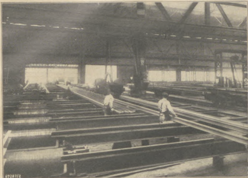
Zurichterei / Fräsen und Bohren von Eisenbahnschienen
