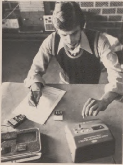
▲ Fritz Niedmers entlädt die im Dosimeter gespeicherte Lärmenergie und errechnet die Lärmsumme des Arbeitsplatzes
