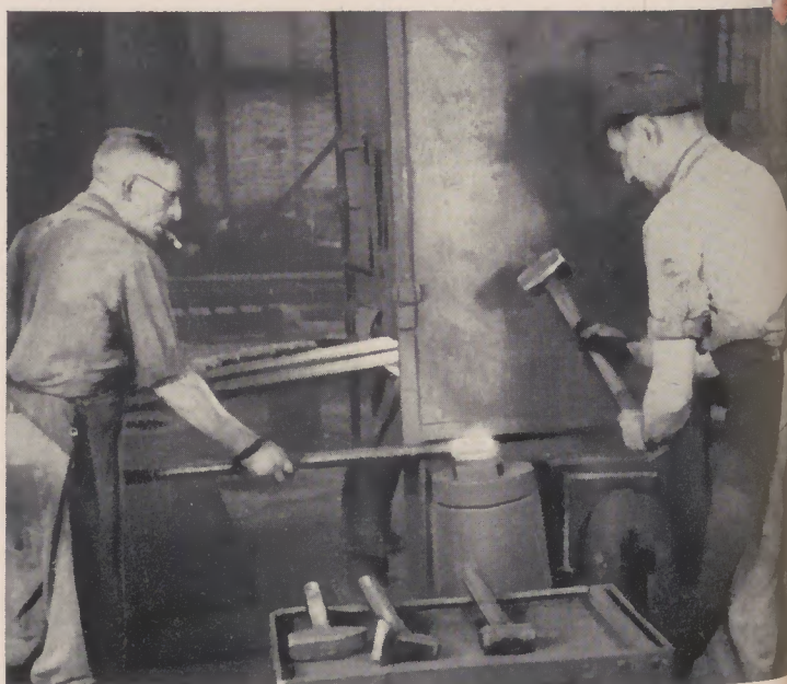
Hier ist der Hammer noch in Tätigkeit: Das Schließen von Backofenrohren (Feuer- oder Preßschweißung).
