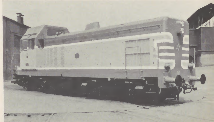
Bild 17 Diesel-elektrische Bo'Bo'-Lokomotive für die Staatsmijnen Limburg/Holland (1956), Dienstgewicht ca. 74 Mp, Leistung 1435 PS, Spurweite 1435 mm
