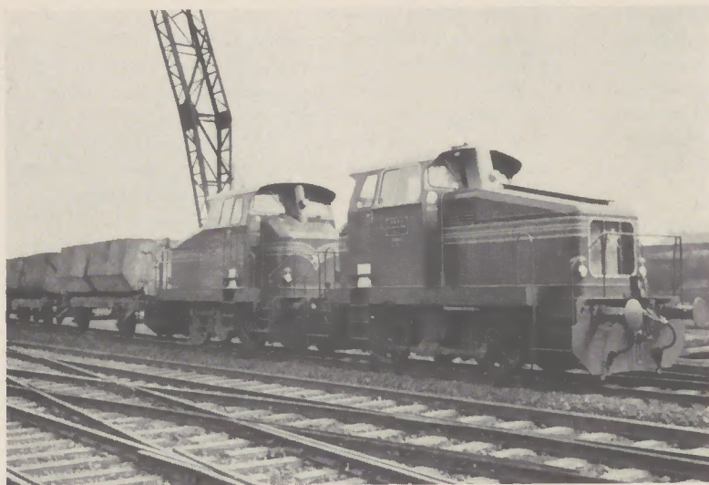
Bild 8 Gekuppelte diesel-hydraulische Henschel-Lokomotiven DH 240 – je 240 PS mit je 1 Motor 6 R 1416 A
