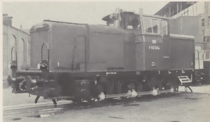
Bild 17 Diesel-elektrische Bo'Bo'-Lokomotive für die Staatsmijnen Limburg/Holland (1956), Dienstgewicht ca. 74 Mp, Leistung 1435 PS, Spurweite 1435 mm
