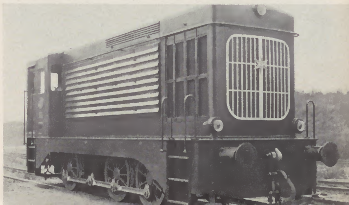
Bild 12 Diesel-hydraulische C-Lokomotive für die Ägyptischen Eisenbahnen (1950), Dienstgewicht 40 Mp, Leistung 380 PS, Spurweite 1435 mm
