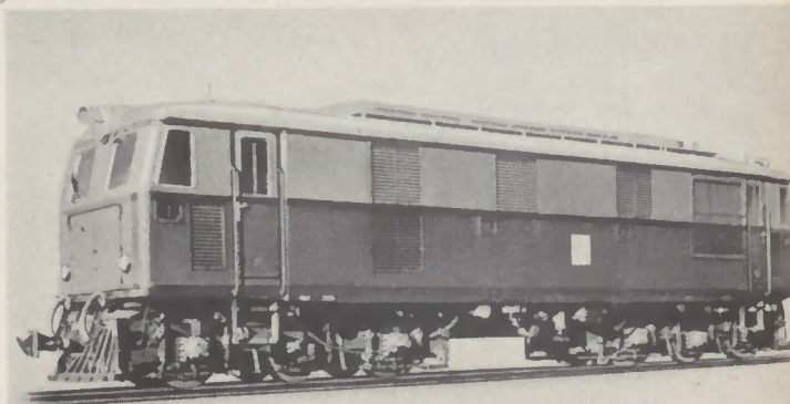
Bild 10 Diesel-elektrische Bo'Bo'-Lokomotive für die Thailändische Staatsbahn (1939), Dienstgewicht 48 Mp, Leistung 730 PS, Spurweite 1000 mm
