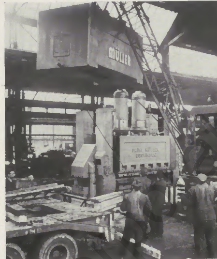
Schwierige Montage: Mitte Juni erfolgte die Montage der neuen Müller-Presse. Als schließlich auch das Querhaupt aufgesetzt war, fiel manchen der Beteiligten ein Stein vom Herzen (oben)
