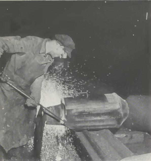
Unrationeller Arbeitsprozeß: Warum soll man immer nur ein Häubchen an den Rohlingen für Vollräder abbrennen, wie auf unserem Bild der Brenner Jakobowski? Diese Frage legte sich eine Erfindergemeinschaft aus dem Stahlwerk vor und...
