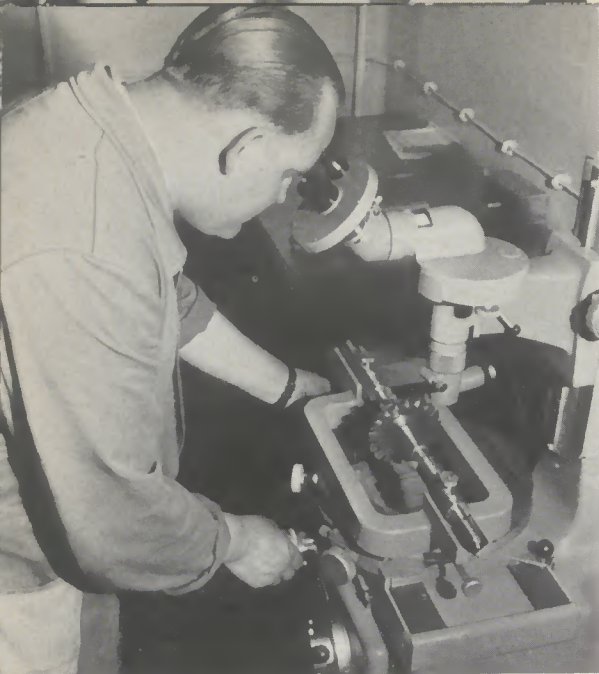
Modernste Meßgeräte: Mit Hilfe eines Universal-Meßmikroskops kann Kontrolleur Wick beim Ausmessen eines Fräasers (unser Bild) kleinste Abweichungen feststellen
