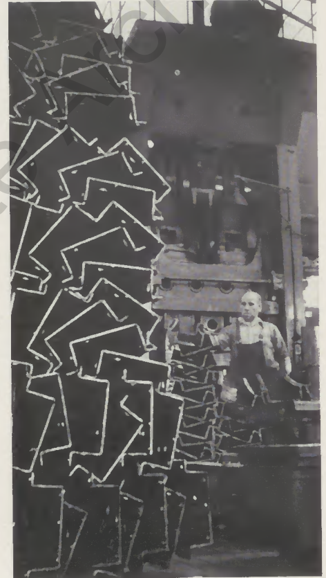
Technische Profile: Der Presser Becker steht an der Kurbelpresse neben hohen Stapeln von kaltgepreßten Querträgern, die ein typisches Erzeugnis des Betriebes II sind
