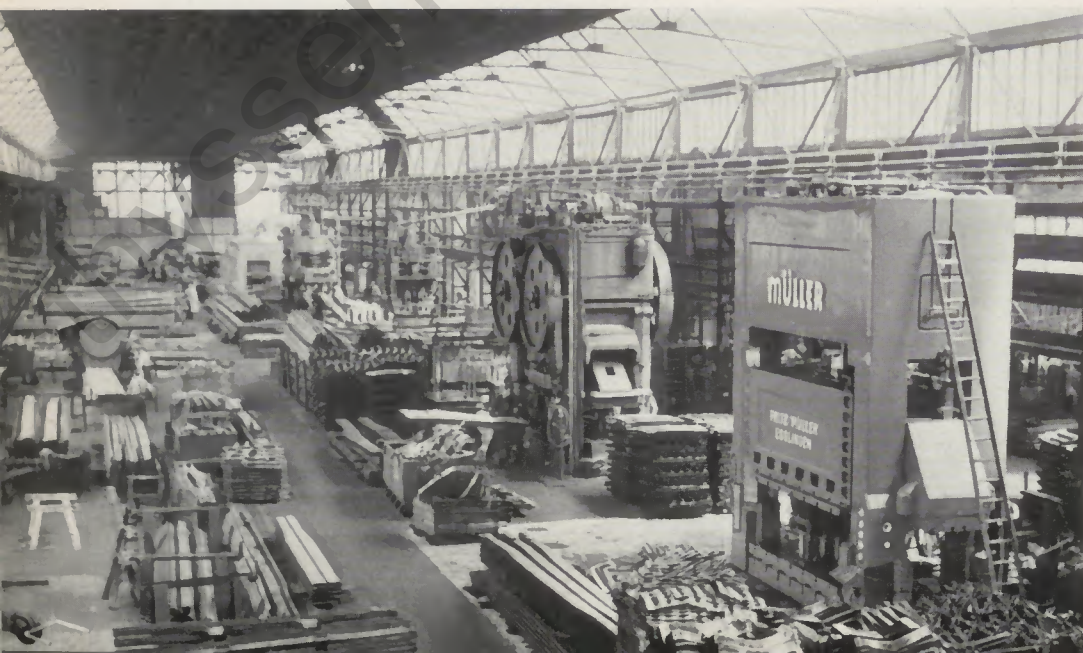
Die großen Pressen: In der Längsrichtung des Hauptschiffs der weiträumigen Werkshalle des B II stehen die schweren Pressen hintereinander gestaffelt. Ihr Produktionsprogramm gab dem Werk den Namen
