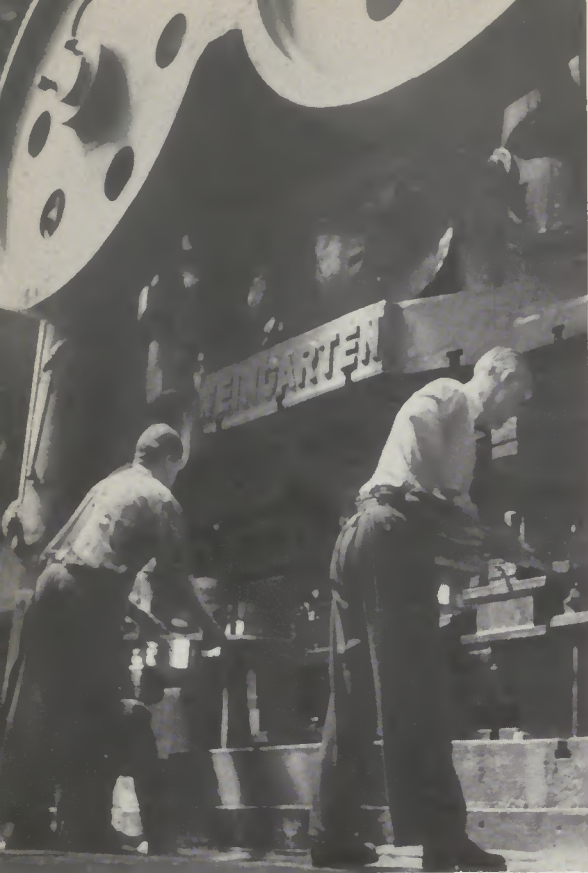
1000 t Druck: Die Weingarten-Presse stellt neben der Langträger- und der Müller-Presse einen wesentlichen Teil der Erzeugung des B II her. An der Maschine (vorn rechts) der stellvertretende Pressenführer Brakowsky (oben)
